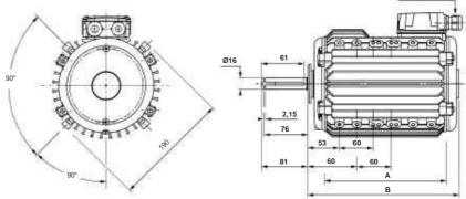
Trous de purge Ø5,7 multi-position sur chaque flasque AV et AR bouchés. Fixation M6 2 ou 4 bossages en fonction de la puissance.
